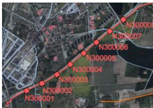
Delsträcka av elnätet till elvägen mellan Malmö och Lund med utsatta nätstationer
