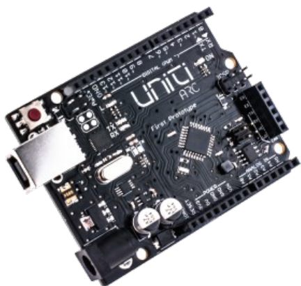
Figur 1: Uniti ARC har samma form och storlek som en Arduino UNO.
